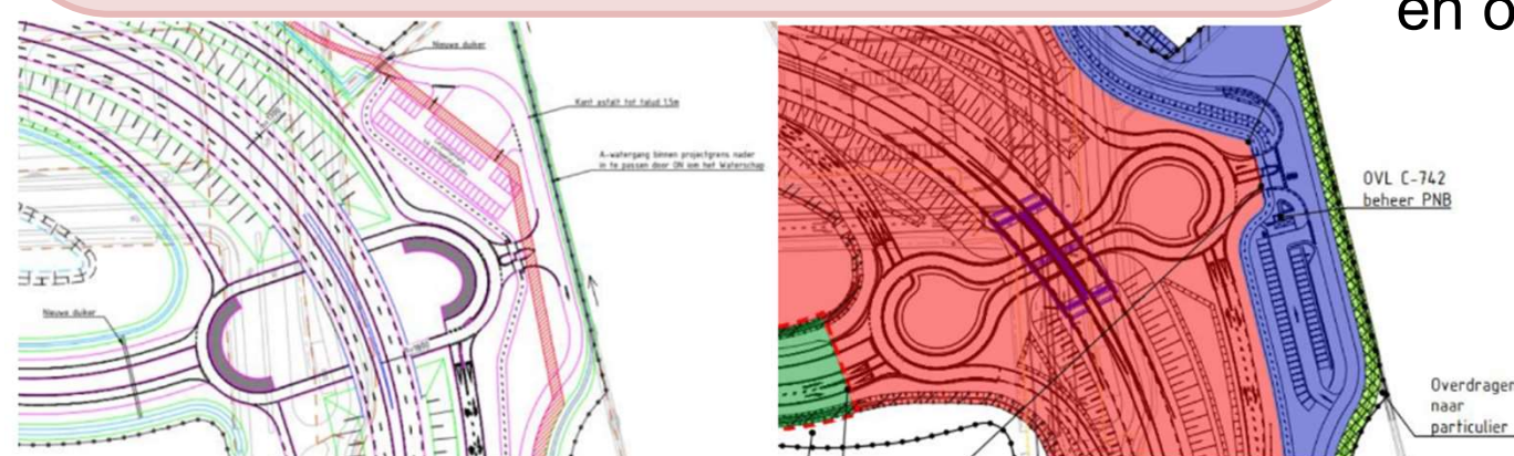
Figuur 1: KW2 – Referentieontwerp met ovatonde (links); ontwerp met kluifrotonde (rechts)
